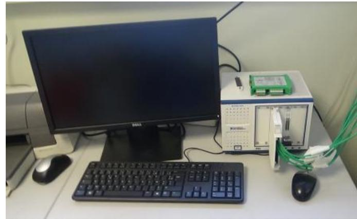
Figure 2 : Système d'acquisition PXI.
