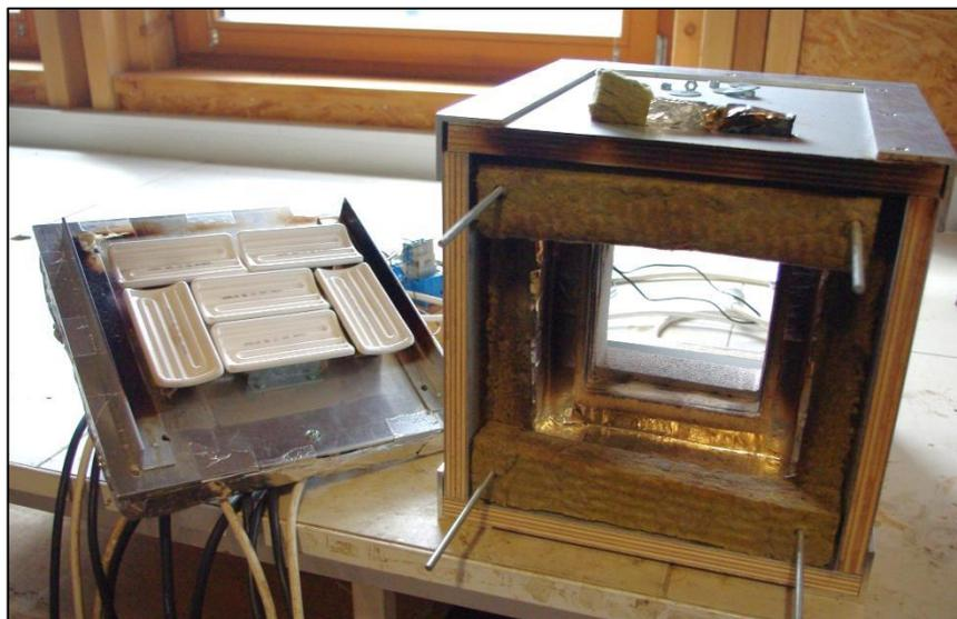
Dispositif d'essai de transfert thermique.
