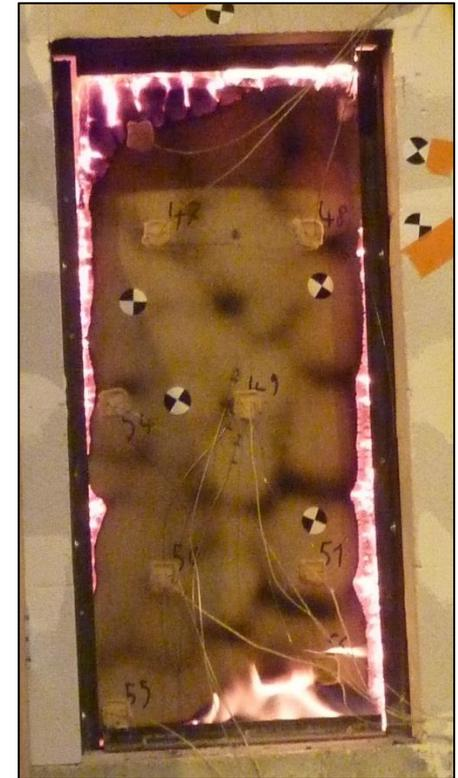
Vue de la face non-exposée d'un panneau d'aggloméré de bois lors d'un essai au feu.
