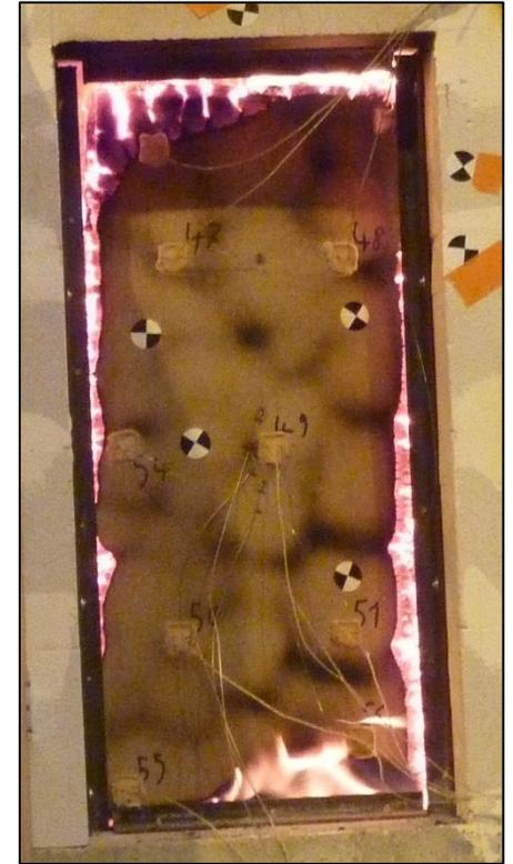
Vue de la face non-exposée d'un panneau d'aggloméré de bois lors d'un essai au feu.
