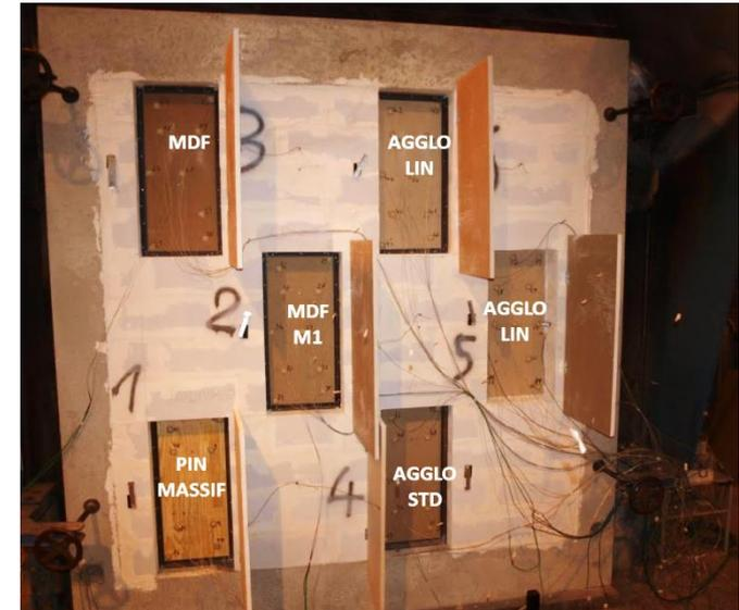
Vue de la face non-exposé du four d'essai.
