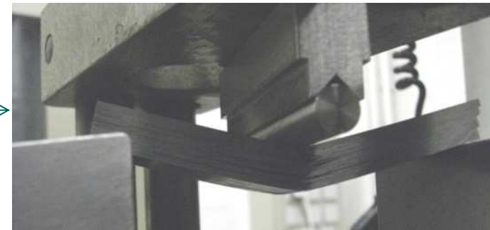
Eprouvette épaisse : endommagement par délaminage successif
