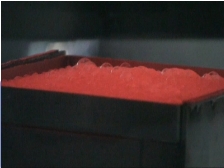
Echantillon de PMMA sous un cône chauffant
