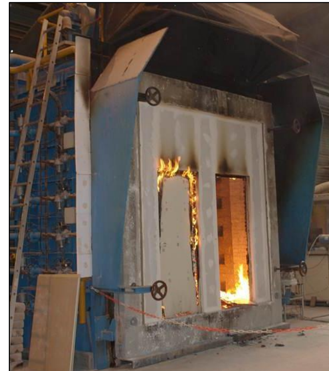
Four vertical d'essai - EFECTIS France
