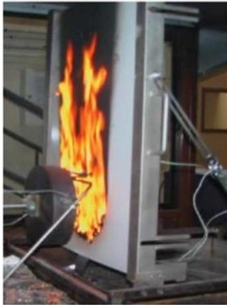
Figure 15: Dispositif du medium burning item [7, 35]
