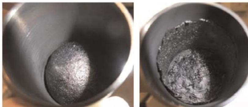
Figure 26 : Photos des échantillons TO-HR500-AT (heating rampe (gauche) et TO-Q500-AT (trempé, (droite)) après essai de compression. [42]
