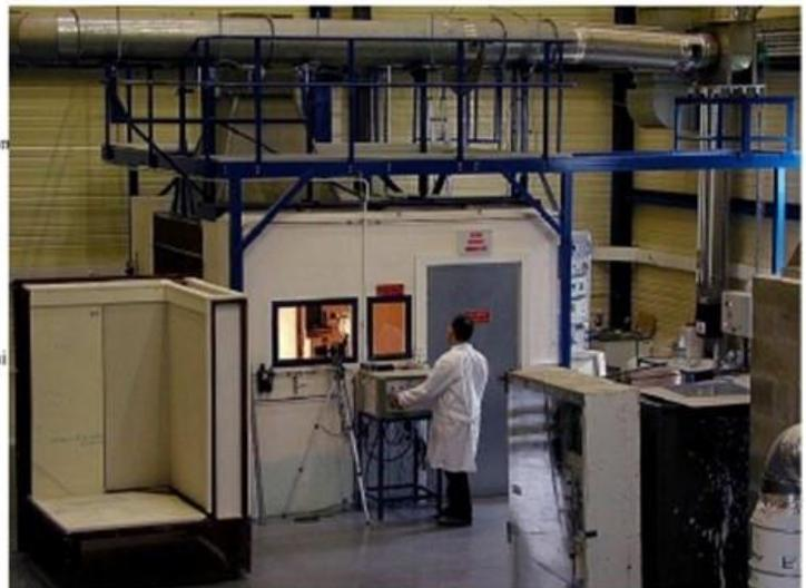
Figure 16 : Dispositif du single burning item [36]
