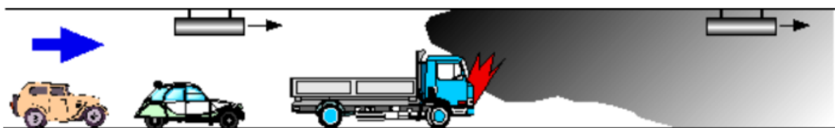
Fig 7 : Illustration du principe de ventilation longitudinale
