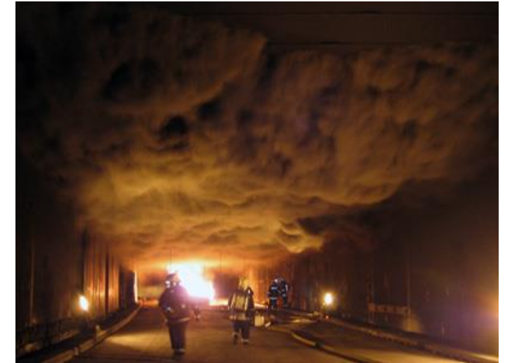
Couche de fumées dans un tunnel
