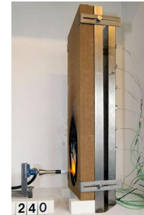
Essai feu couvant (1) selon NF EN 16733
