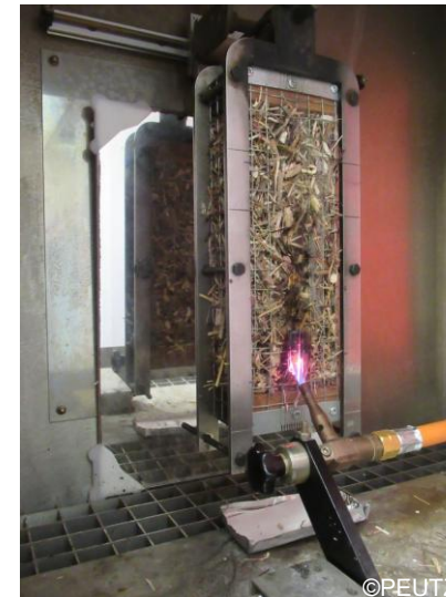
Attaque par une petite flamme (EN ISO 11925-2)
