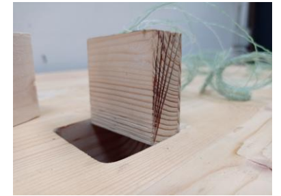
Technique des thermocouples noyés adaptée à l'échelle intermédiaire
