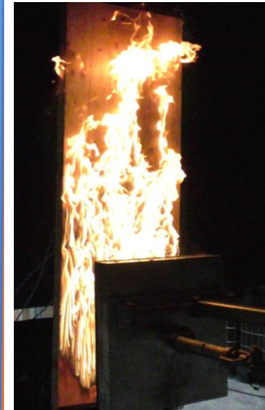
Technique des thermocouples noyés adaptée à l'échelle intermédiaire
