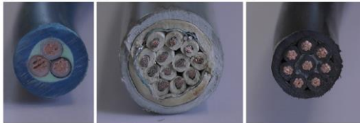
A et B : câbles PE/EVA-ATH C : câble PVC
