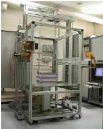
Conductimètre de référence métrologique de type PTGHT [+23 ; +800 °C] développé au LNE
