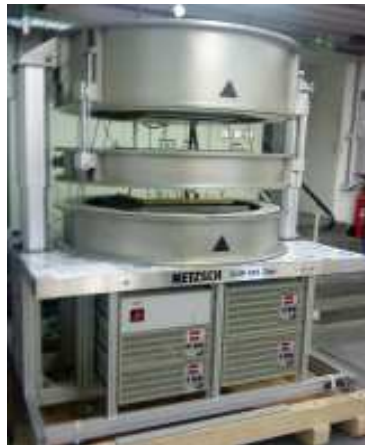
Conductimètre de référence métrologique de type PTGBT et PTGHT [-180 °C ; +700 °C]
