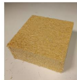
Fibre de bois avant essai
