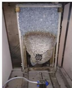
Essai au CSTB sur panneau de coton suivant la norme NF EN 16733
