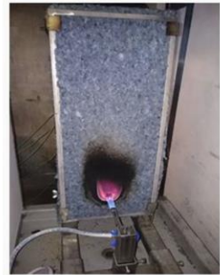
Essai au CSTB sur panneau de coton suivant la norme NF EN 16733
