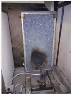
Essai au CSTB sur panneau de coton suivant la norme NF EN 16733
