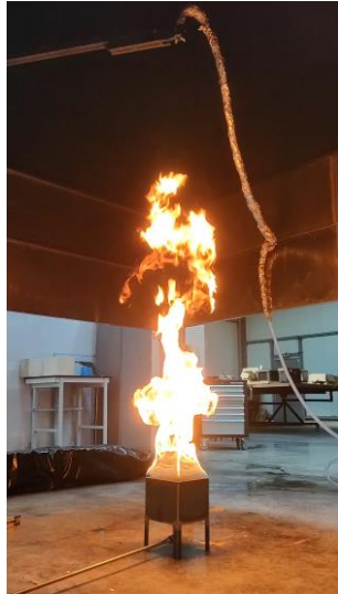
Vidéo 1 : Brûleur propane exposé à une buse TG
