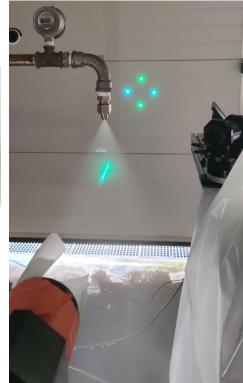
Figure 18 : Photo d'une buse TG en fonctionnement
