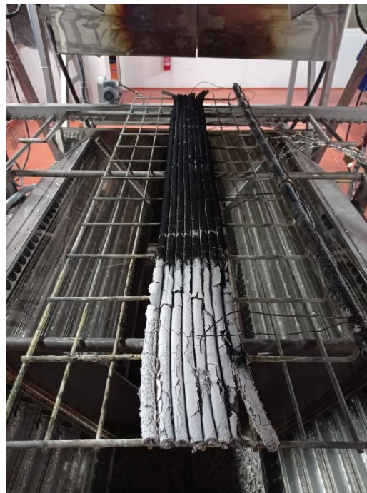
Résidu d'un essai de propagation avec un chemin de câbles PE/EVA/ATH
