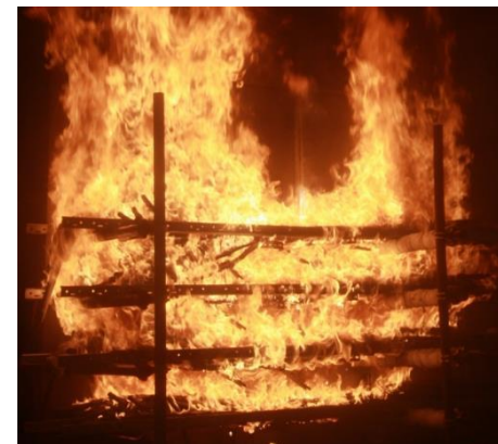
Feu de chemins de câbles (PRISME-2)
