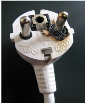
mauvais contact (vis de connexion PC)
