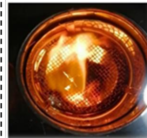
Ignition dans phase solide & gaz
