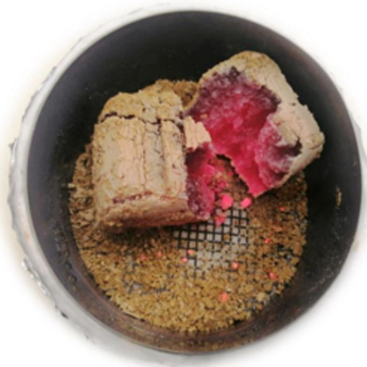
Echantillon sorti du CCAC (après un test sous air, sous 20\text{kW/m}^2 , pendant 5000 secondes)
