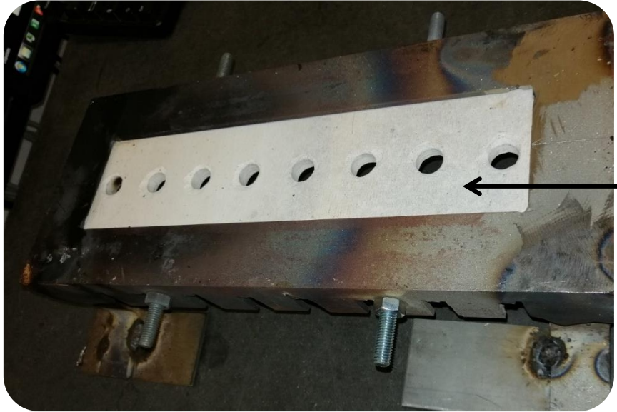
Plaque d'étalonnage 270 x 80 x 10 mm
