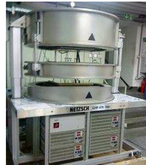
Plaque chaude gardée de référence pour la mesure de conductivité thermique des matériaux isolants [-160°C; +700°C]
