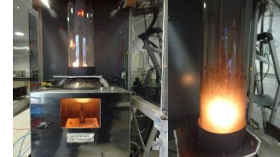
Combustion en mode sous ventilé
