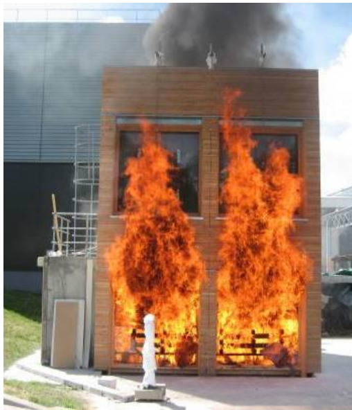
Essai LEPIR - Feu de façade Interaction flamme paroi
