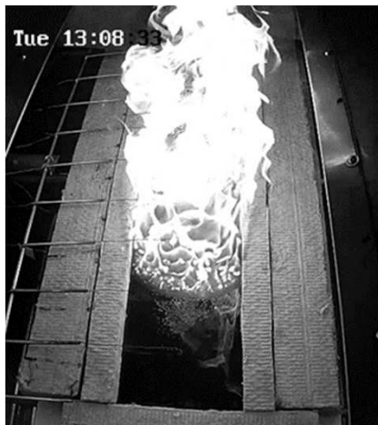
Essai de propagation du feu sur une plaque horizontale de black PMMA (dispositif CISCCO)
