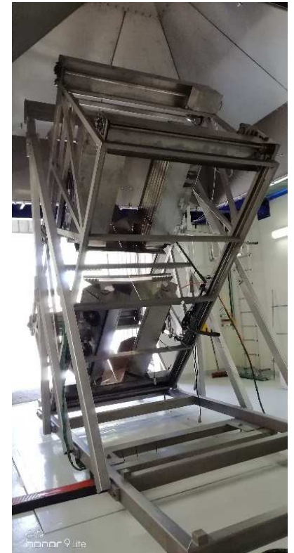
Inclinaison du dispositif CISCCO à l'aide de la potence
