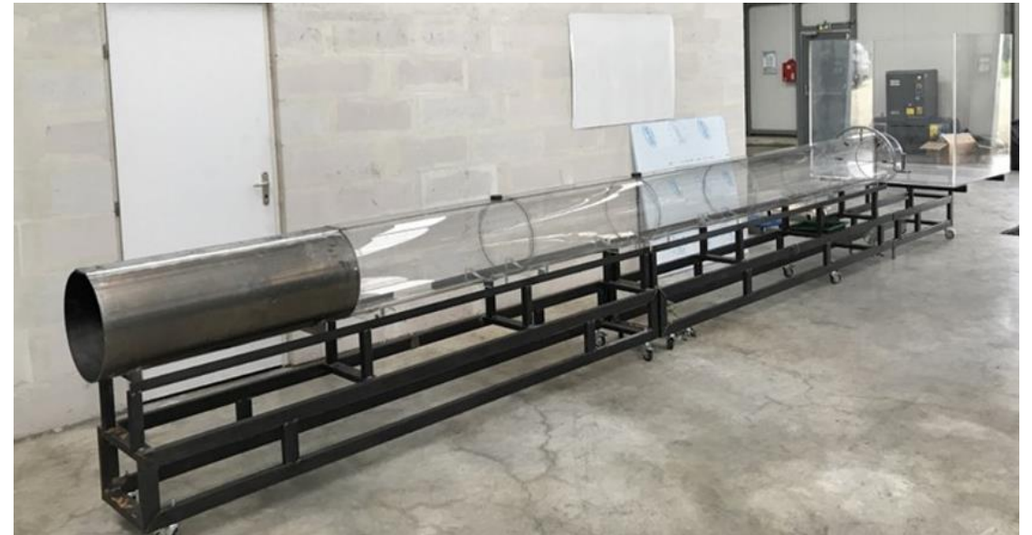
Tunnel fermé d'un côté (vers lequel le tunnelier creuse) dit borgne
