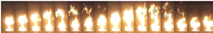
(a) Phénomène d'oscillation de la flamme
